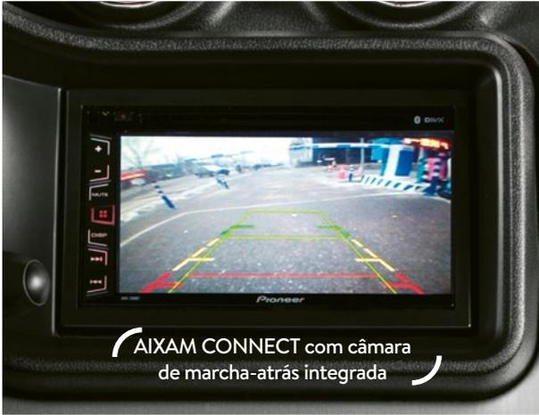
AIXAM CONNECT com câmara de marcha-atrás integrada
